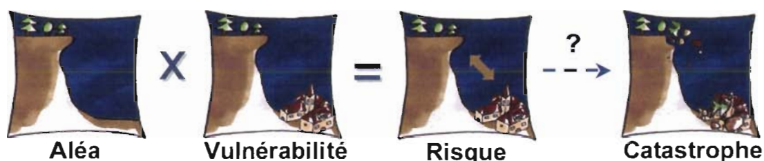
Figure 6.3 – Illustration de la notion de risque et de ses composantes, traditionnellement utilisée en gestion des risques naturels. La flèche en pointillés indique que la survenue d'une catastrophe n'est pas systématique lorsqu'il y a risque, mais dépend de l'intervention d'un élément extérieur potentiel, qu'illustre le point d'interrogation. (Source des images : http://www.irma-grenoble.com/04risques/index.htm ).
