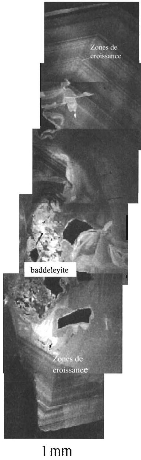
Figure V-8: Cristal de zircon ( \text{ZrSiO}_4 ) inclus dans un saphir d'Ambondromifehy et observé par cathodoluminescence. Nous remarquons les différentes zones de croissance qui sont parallèles aux bordures du cristal. Le cœur du cristal est corrodé et transformé partiellement en baddéleyite ( \text{ZrO}_2 ).
