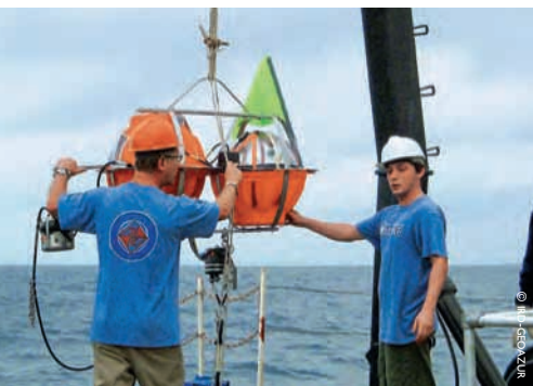
Immersion d'un sismomètre, Équateur.
