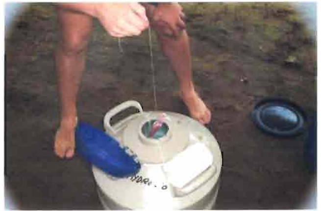
Mise dans l'azote liquide d'un échantillon pour dosage d'Aluminium
