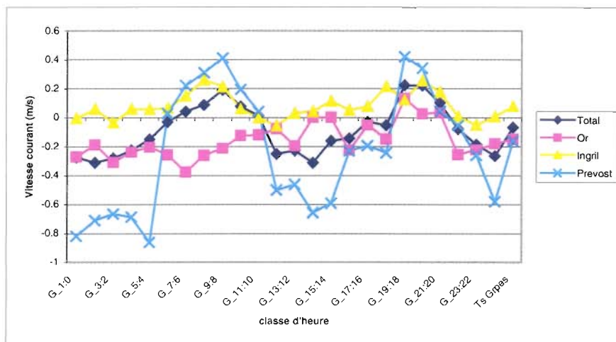
Figure 6 : variations du sens et de l'intensité du courant par heure ; dans les graus durant les missions d'observations acoustiques
