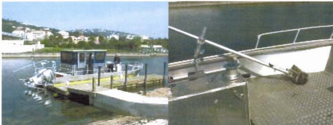
Figure 1 : Le Chlamys (2*110CV, 9m) à quai au CRHMT de Sète (IRD, Ifremer, UM2), à bord B. Liorzou et Y. Guénégan durant l'installation du « PC scientifique » et du tube articulé conçu pour fixer le transducteur du sonar. A droite : Bras articulé soutenant la base du sonar multi-faisceaux.
