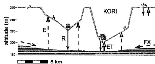
**Figure 5** Schema conceptuel du fonctionnement à l'équilibre de la dépression piézométrique du kori de Dantiandou Un flux d'évaporation généralisé (E) et une évapotranspiration dominante au centre (ET) sont compensés par des flux de recharge localisés (R) et de faibles flux latéraux (FX)
