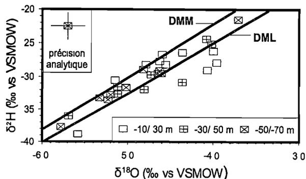
**Figure 3** Teneurs en  $^{18}\text{O}$  et  $^2\text{H}$  pour les eaux de la nappe libre DMM, DML droite météorique mondiale, droite météorique locale Les symboles représentent différentes gammes de profondeur de la nappe
