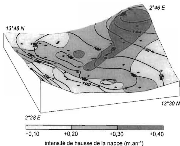
**Figure 2.** Bloc-diagramme de la partie centrale de la dépression (cf. Fig. 1) et carte superposée des intensités de la hausse piézométrique interannuelle (1991–1998, en  $\text{m an}^{-1}$ ).
