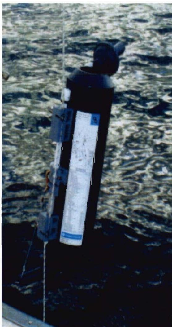
**Figure 5 : Bouteille NISKIN de 5 litres**
