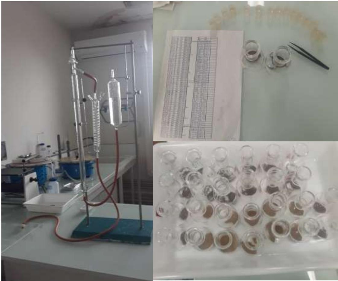
Figure 24 : Décarbonation au calcimètre de Bernard pour la mesure de la teneur en carbone organique total (COT) par la méthode CHN (Laboratoire de l'UMR Eco&Sol, Montpellier) : a) Calcimètre de Bernard ; b) et c) : préparation des échantillons de sol de la solution.
