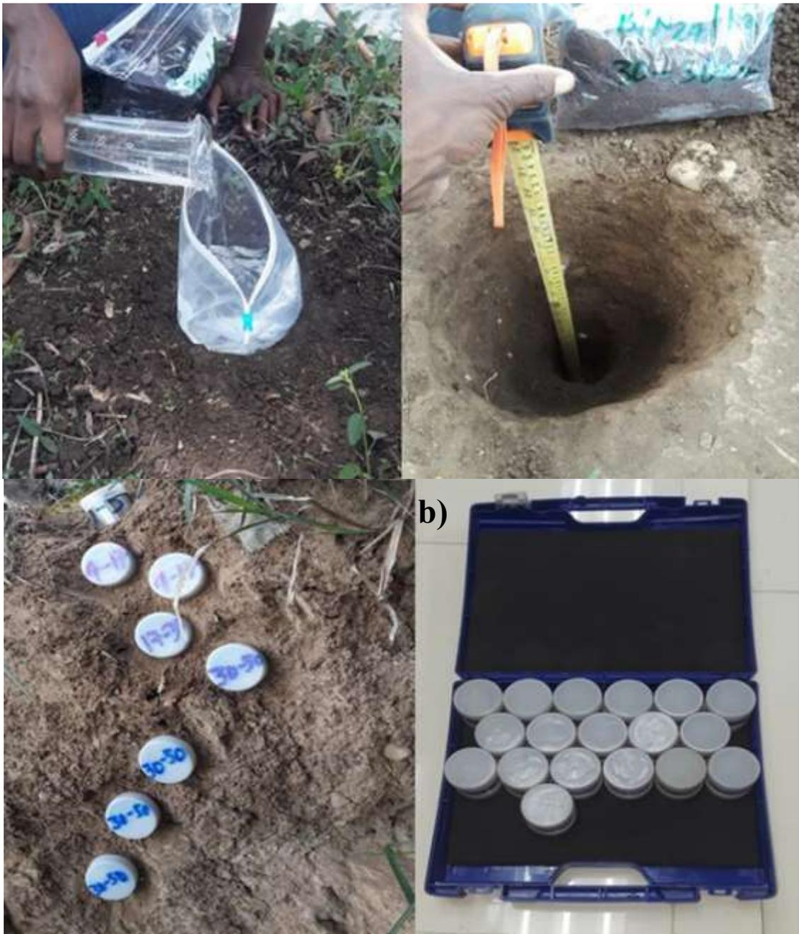
Figure 23 : Prélèvements des sols pour la mesure de la densité apparente : a) méthode à l'eau ; b) méthode de cylindre
