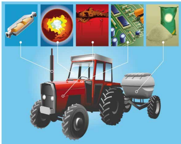
FIG. 60 – Les réactions de surface sont essentielles dans de nombreux processus de nos jours. Dans le nettoyage catalytique, le monoxyde de carbone s'oxyde sur le platine. Les fréons utilisés par exemple dans les systèmes de climatisation réduisent la couche d'ozone en réagissant à la surface de petits cristaux de glace. La rouille apparaît lorsqu'une surface de fer est exposée à l'oxygène. Les réactions de surface sont utilisées dans l'industrie électronique pour fabriquer des matériaux semi-conducteurs. Les engrais artificiels contiennent de l'ammoniac qui est produit lorsque l'azote et l'hydrogène réagissent sur une surface de fer. Les carburants renouvelables peuvent être produits à l'aide de surfaces catalytiques.
