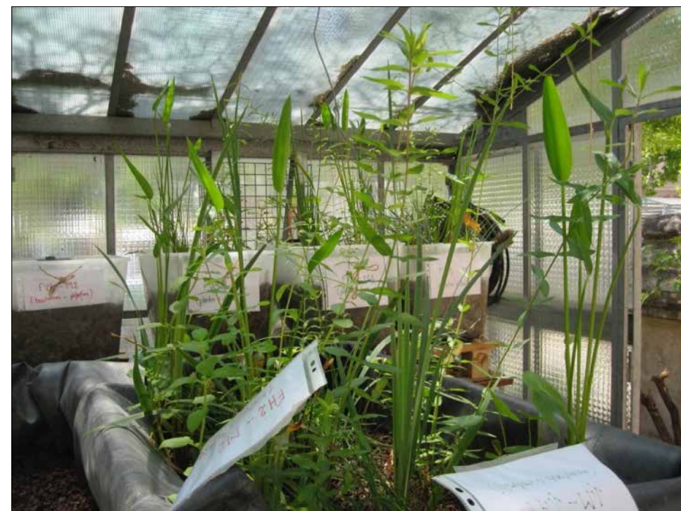
Figure 3 : Installation en serre de filtres mixtes de phytoépuration à échelle réduite pour leur évaluation dans le traitement de lisier de porc (Juillet 2011, thèse de Julie Nehmtow)
