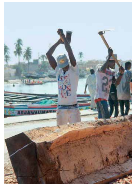
Taille d'un tronc d'arbre par des aides charpentiers pour constituer la quille d'une grande pirogue en planches à Saint-Louis du Sénégal.
