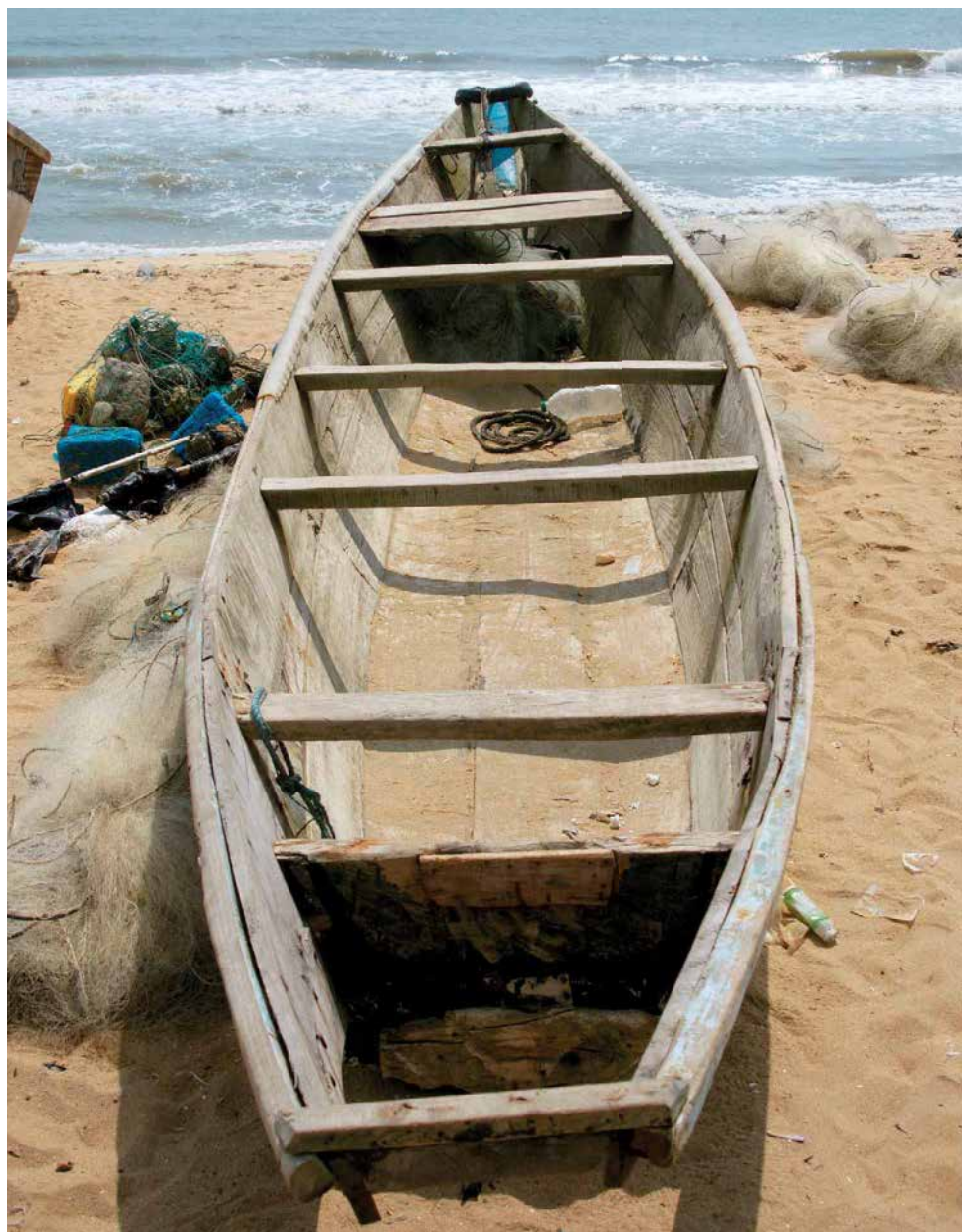
Essai de pirogue en planches sans base monoxyle (PLA) afin de pallier le manque de disponibilité de troncs d'arbre suffisamment grands pour assurer la construction de la quille, Bénin.
