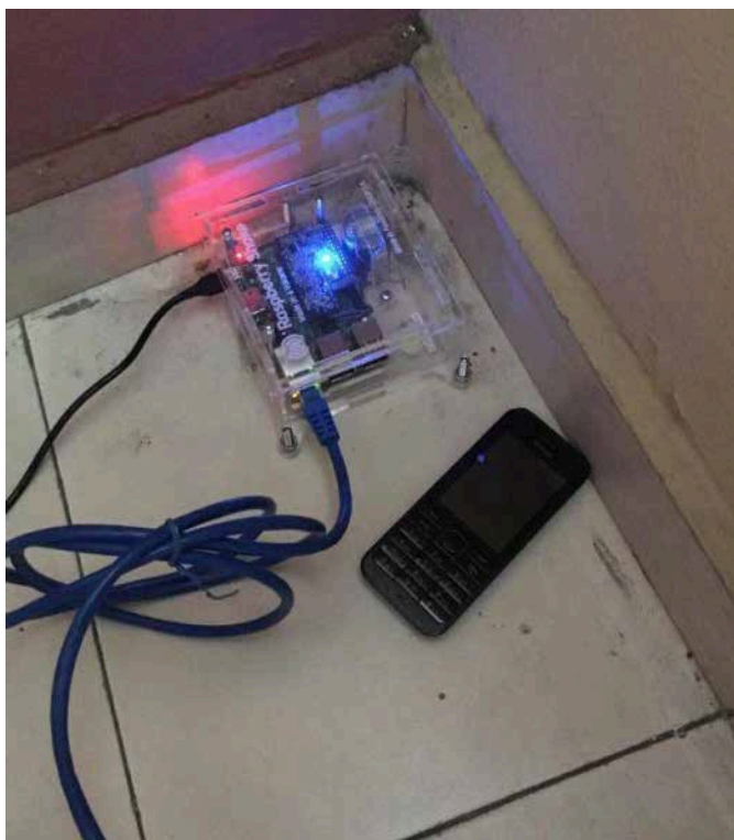
Figure 1 - Photo d'un sismomètre Raspberry Shake, installé chez un hébergeur à Port-au-Prince. Le téléphone portable donne l'échelle.
