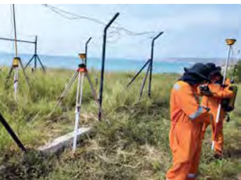
Stations satellitaires pour suivre le trait de côte et calculer la propagation des tsunamis, Équateur.
