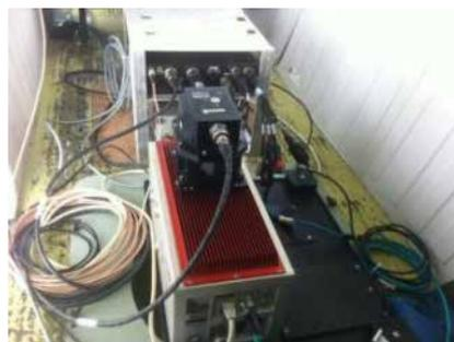
Le poste de pilotage est équipé d'un Système de Guidage (Applanix : POSTRACK AV 510) permettant à l'opérateur de contrôler et vérifier le positionnement de l'aéronef et de s'assurer du bon fonctionnement du GPS et de la centrale inertielle.
