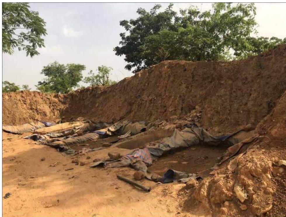
Illustration 1 - Bassins de cyanuration clandestins, Diébougou, Sud-Ouest du Burkina Faso, avril 2019
