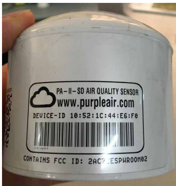
FIG. 4.2A PurpleAir sensor (Jessica Pourraz)
