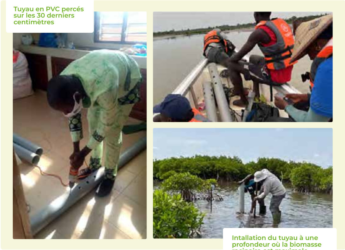
Figure 16. Installation de tuyaux en PVC dans les sous-parcelles de reboisement pour la collecte d'échantillons d'eau et la mesure des paramètres physico-chimiques in situ, conformément à Agraz Hernández et al. (2007). © C. Agraz Hernández
