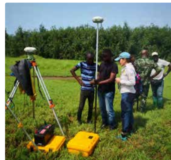
Figure 19. Détermination du niveau topographique avec la méthodologie RTK au Bénin (photo à gauche) et distribution microtopographique d'une forêt de mangrove dégradée sur un site de Cuajiniquil, Costa Rica, 2018 (photo bas).
