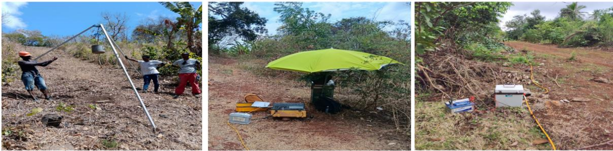
Fig. 1 – Dispositif d'acquisition sismique à gauche (source) et au centre (Smartseis -Geometrics), à droite dispositif électrique (Syscal Pro – IRIS Instruments).
