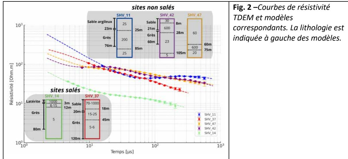
**Fig. 2 –Courbes de résistivité TDEM et modèles correspondants. La lithologie est indiquée à gauche des modèles.**
