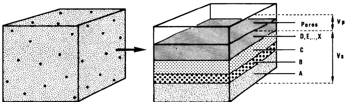
FIG. 1. – Solide homogène, poreux, constitué des éléments A, B... X
