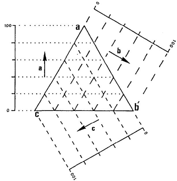
FIG. 2. – Représentation des proportions relatives a, b et c des éléments A, B et C (cf. fig. 1) dans un diagramme triangulaire
