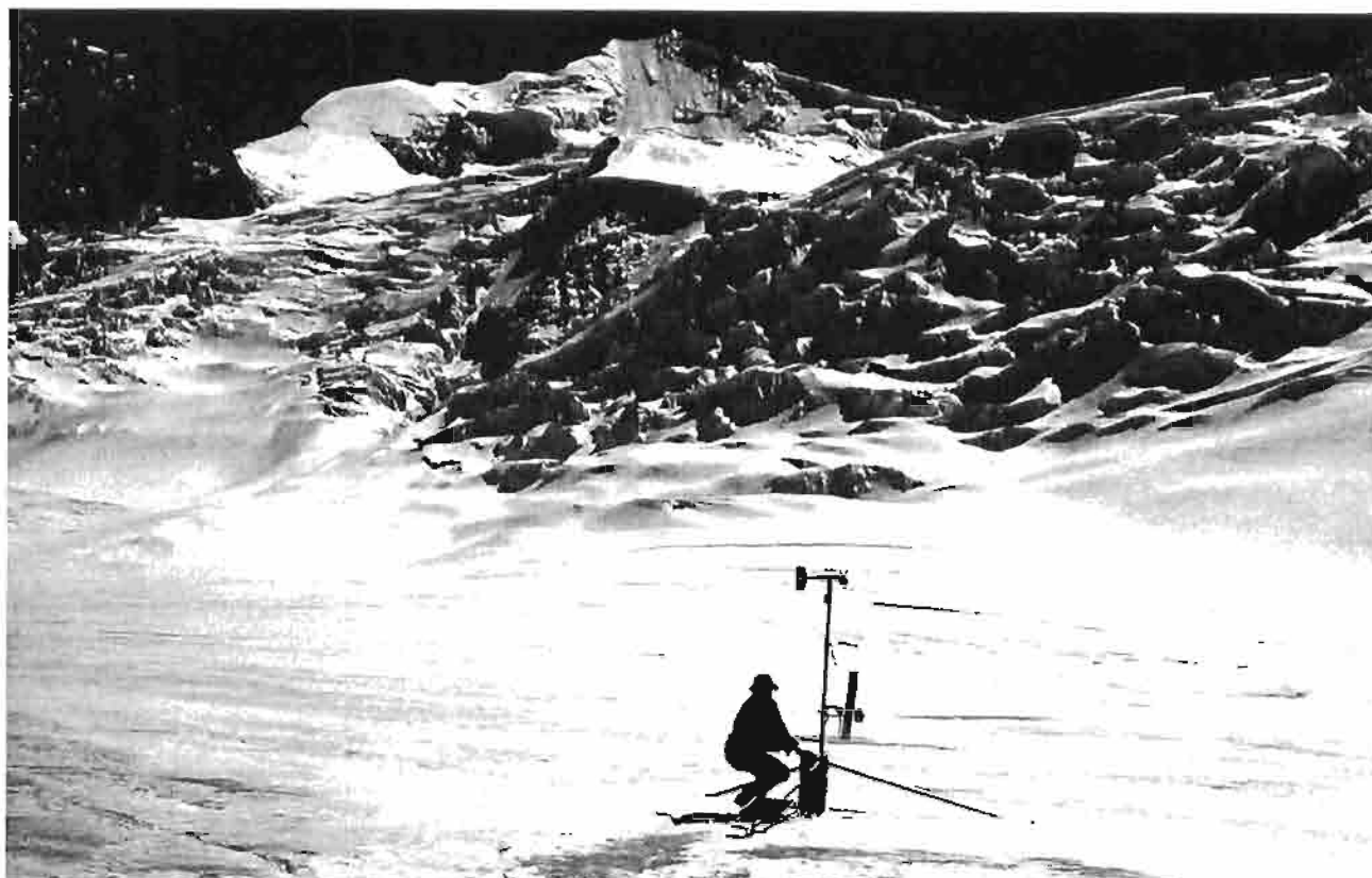
Figura 5 - Misure di bilancio energetico sul Ghiacciaio di Zongo (Bolivia) per mezzo di una stazione automatica mobile d'altitudine. I dati raccolti sono comparati con quelli di una stazione fissa, che presenta sensori a diverse altezze dal suolo, situata alla stessa altitudine sulla morena laterale. (B. Francou).
