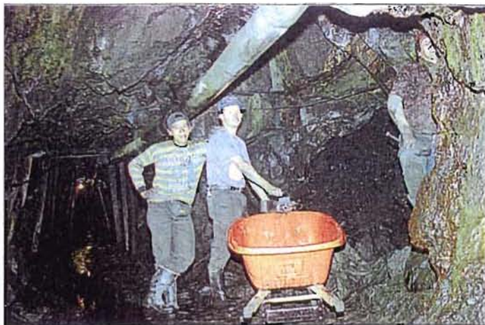
Figure 14. La galerie d'accès aux fronts de taille. Les déblais sont évacués vers l'extérieur à l'aide de brouettes. La gaine de polyéthylène amène l'air frais. Photo V. Castañeda.
