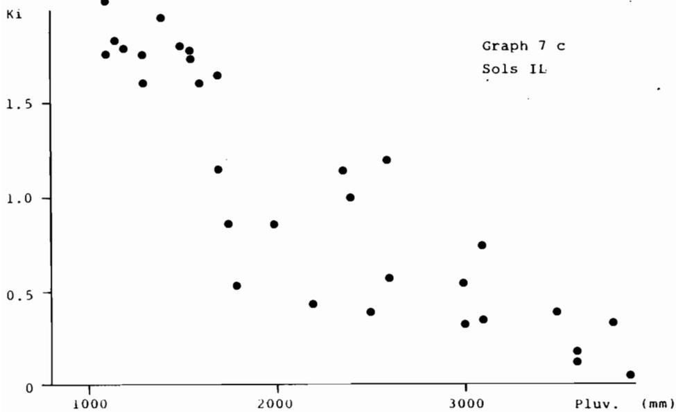
Variation du Rapport  $K_i = SiO_2/Al_2O_3$  en fonction de la pluviométrie
