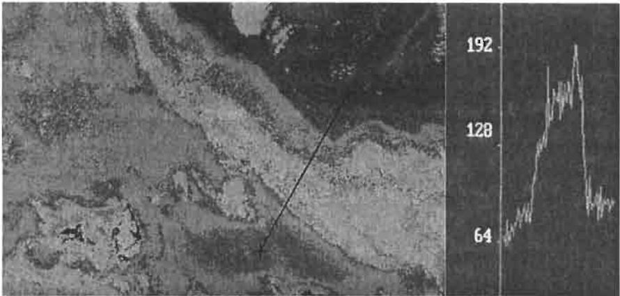
Figura 8 Imagen del satélite CZCS mostrando los niveles de concentración de pigmentos clorofílicos (fecha 28 diciembre 1979). La gráfica a la derecha indica los valores de cada pixel a lo largo del transecto que corta la pluma del río Orinoco.
