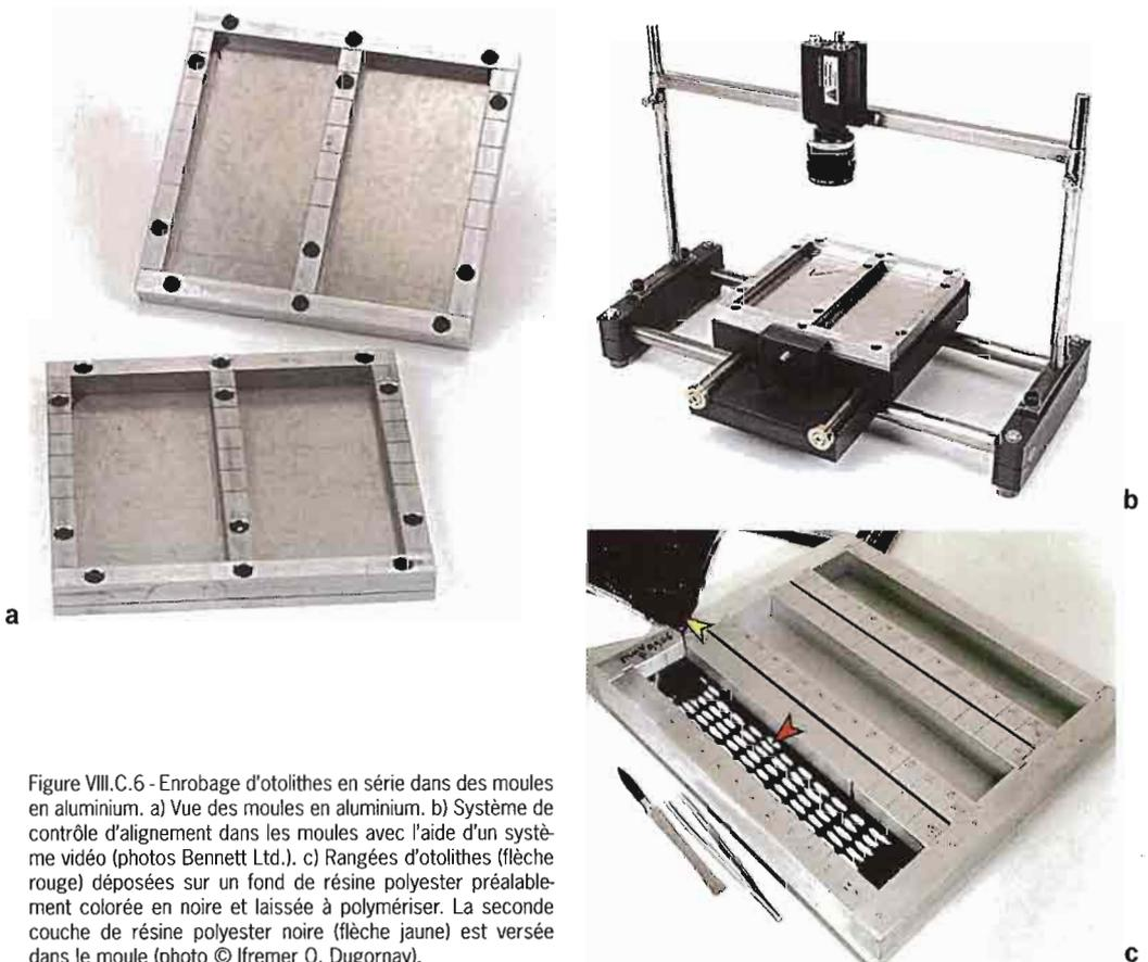
Figure VIII.C.6 - Enrobage d'otolithes en série dans des moules en aluminium. a) Vue des moules en aluminium. b) Système de contrôle d'alignement dans les moules avec l'aide d'un système vidéo (photos Bennett Ltd.). c) Rangées d'otolithes (flèche rouge) déposées sur un fond de résine polyester préalablement colorée en noire et laissée à polymériser. La seconde couche de résine polyester noire (flèche jaune) est versée dans le moule (photo © Ifremer O. Dugornay).
