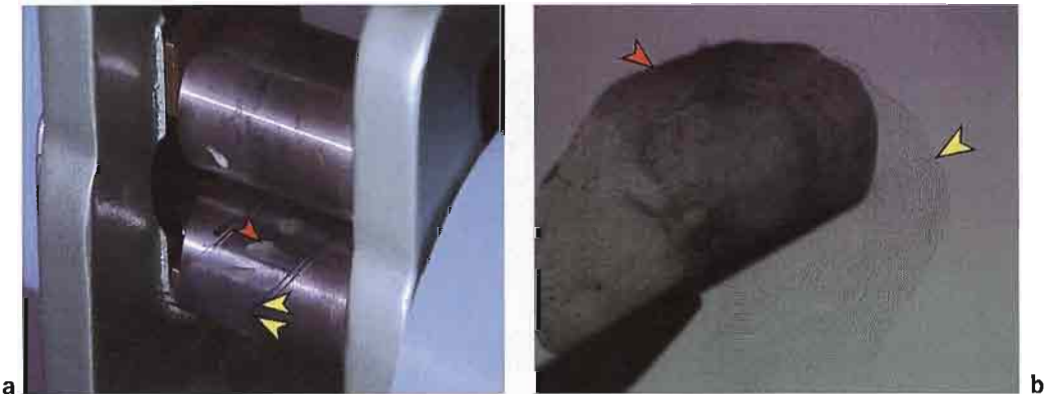
Figure VIII.C.2 - Impression d'écaïlle sur feuille d'acétate de cellulose. a) Les écailles (flèche rouge) sont positionnées entre 2 feuilles d'acétate (flèches jaunes). L'ensemble est passé entre les deux rouleaux d'une presse (e.g. presse de joaillier). b) La face externe de l'écaïlle (flèche rouge) est alors séparée de la feuille d'acétate (flèche jaune) et son empreinte reste visible (flèche jaune) (photos © Ifremer O. Dugornay).
