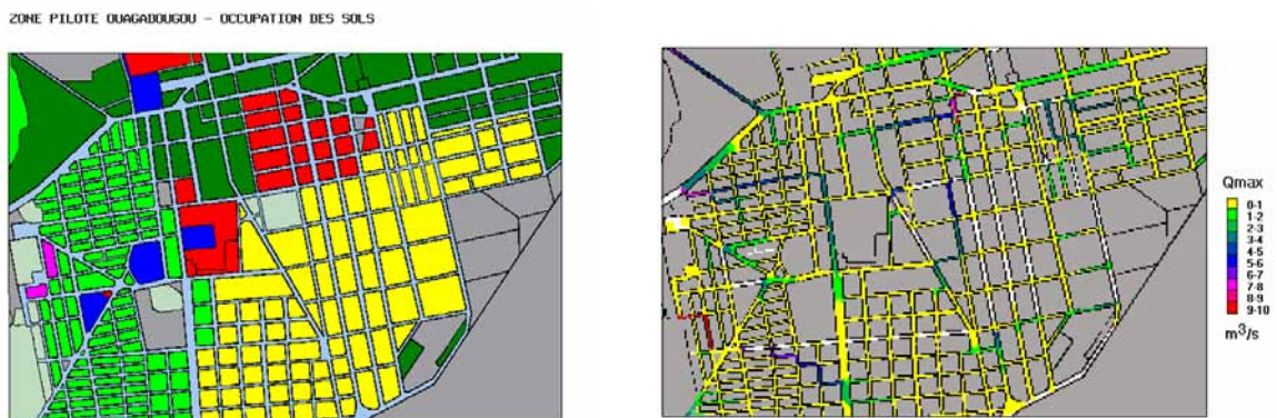
Figure 4.4 : Débits maximum transitant par les voiries d'un secteur urbanisé de Ouagadougou pour une pluie de période de retour cinquantennale
