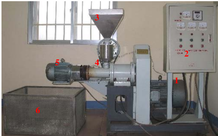
Photo I/2: Le CE-TFC de 2 nd génération (EX800) et ses principales composantes.
