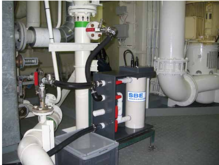
Figure 3. Thermosalinographe (type SeaBird SBE21) installé en salle des machines sur le navire marchand Nokwanda navigant dans l'Atlantique entre l'Europe et l'Afrique du Sud (Photo : D. Diverrès, IRD-Brest).
