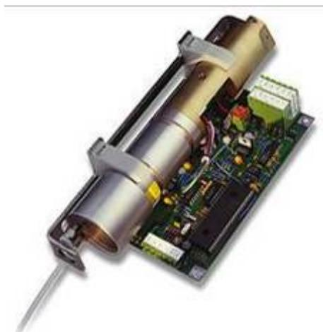
Figura 6.16. Detalle del equipo Limnógrafo Nimbus de marca OTT
