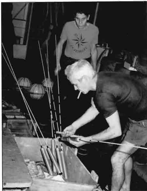
Préparation d'un préleveur autonome à nodules polymétalliques.
