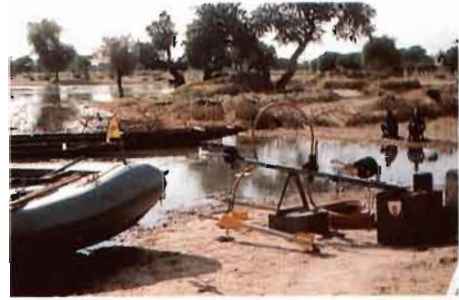
Matériel de jaugeage pour mesurer le débit des cours d'eau.
