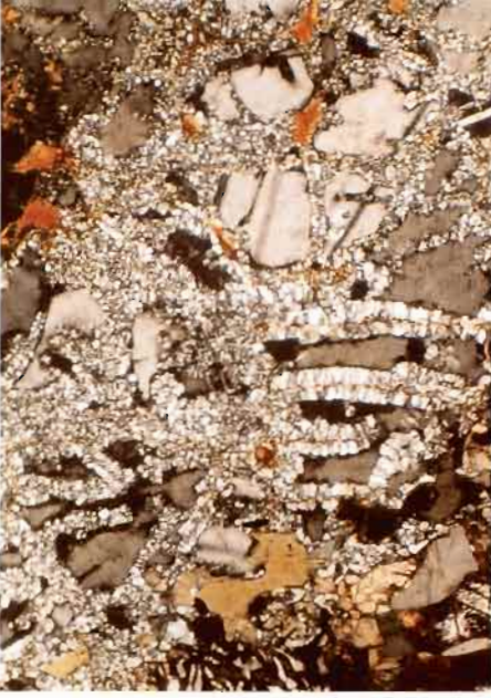
Feldspath partiellement altéré en très petits cristaux de gypse.
