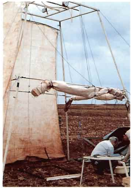
Simulateur de pluie à Pejuçara. Etat Rio Grande do Sul. Brésil.
