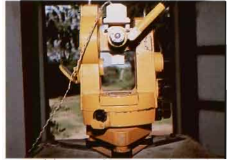
Appareil de mesure donnant une référence de la valeur des composants du champ magnétique terrestre. Centre de géophysique de Mbour. Sénégal.
