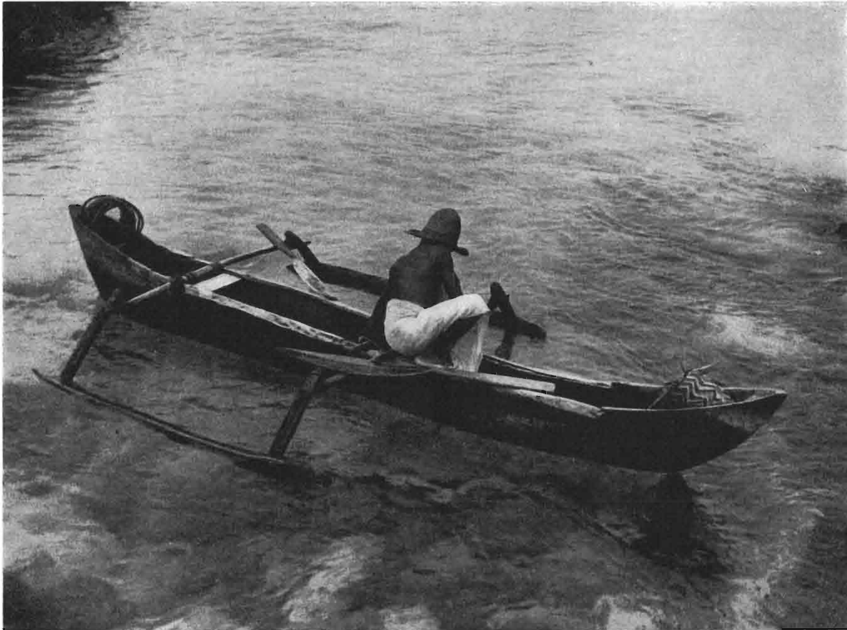
FIG. 2. — Pirogue de pêche à balanciers en usage aux Comores et à Madagascar.
