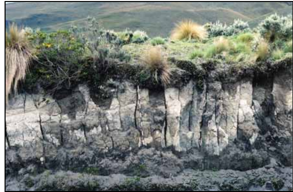
Photo 61 : Fentes de retrait donnant une structure prismatique très grossière dans un andosol asséché par la construction d'une route.
