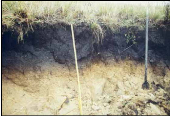
Photo 35 : Profil 7-SAR. Andosol sur oxisol sur le Fierro Urcu. Une stone line sépare un horizon humifère épais de 50 cm reposant sur une altération de roche volcano-sédimentaire.
