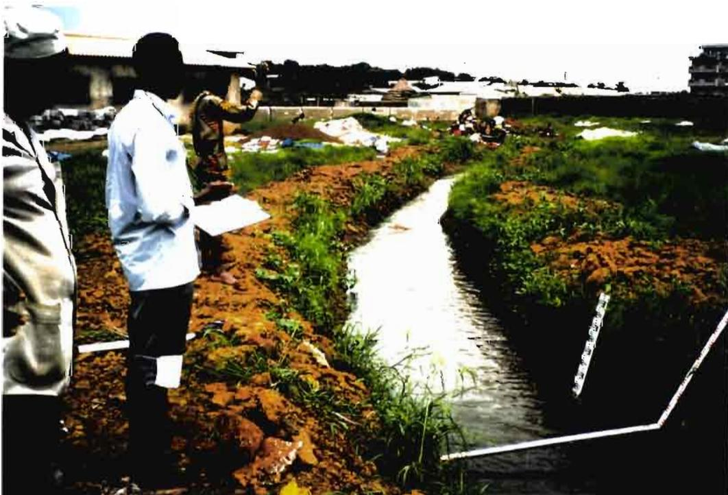
Entraînement au jaugeage aux flotteurs sur le terrain
