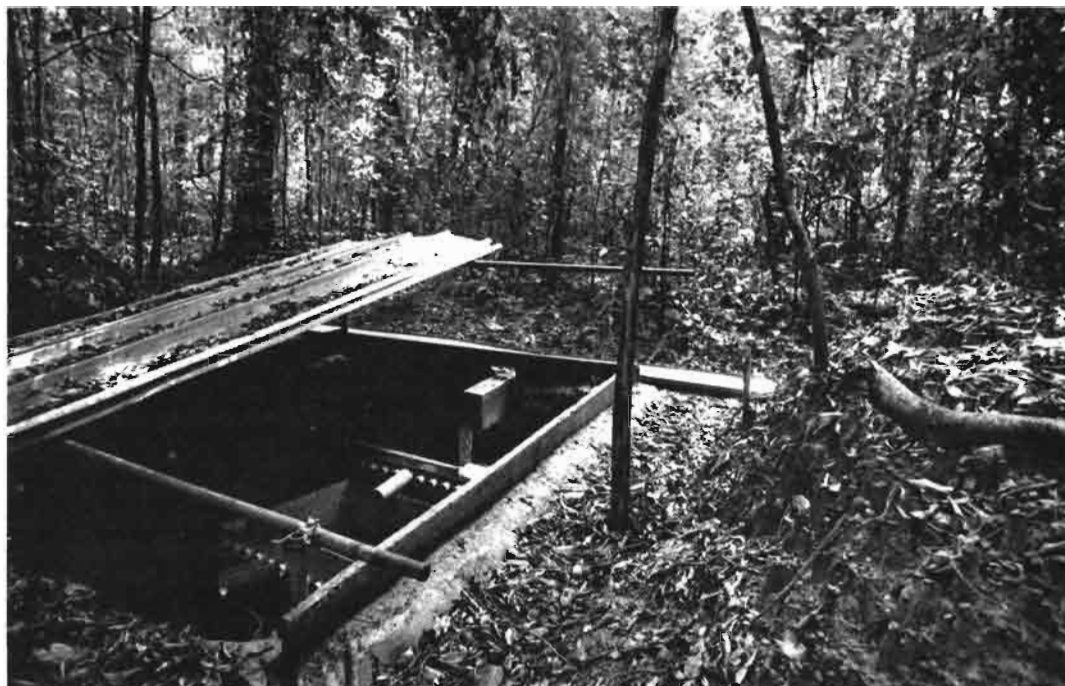
Photo 14. Cuve à partiteurs destinée à recueillir les eaux et les charges solides à l'aval de la parcelle d'érosion
