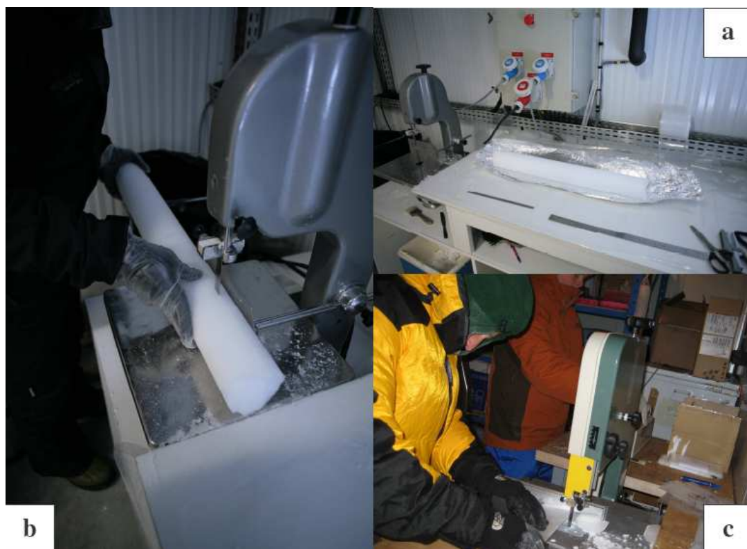
Figure 1-13: Découpage de la carotte de glace du San Valentin en chambre froide: a) une section de 70cm à Grenoble; b) découpage de la section au LGGE à Grenoble; c) découpage des échantillons de 2cm au LSCE à Saclay (J.-D. Taupin et N. Patris à la manoeuvre).
