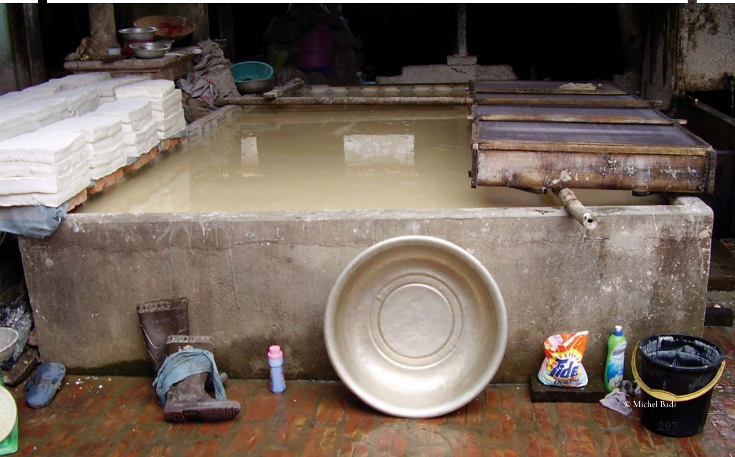
BỂ LỌC BỘT
