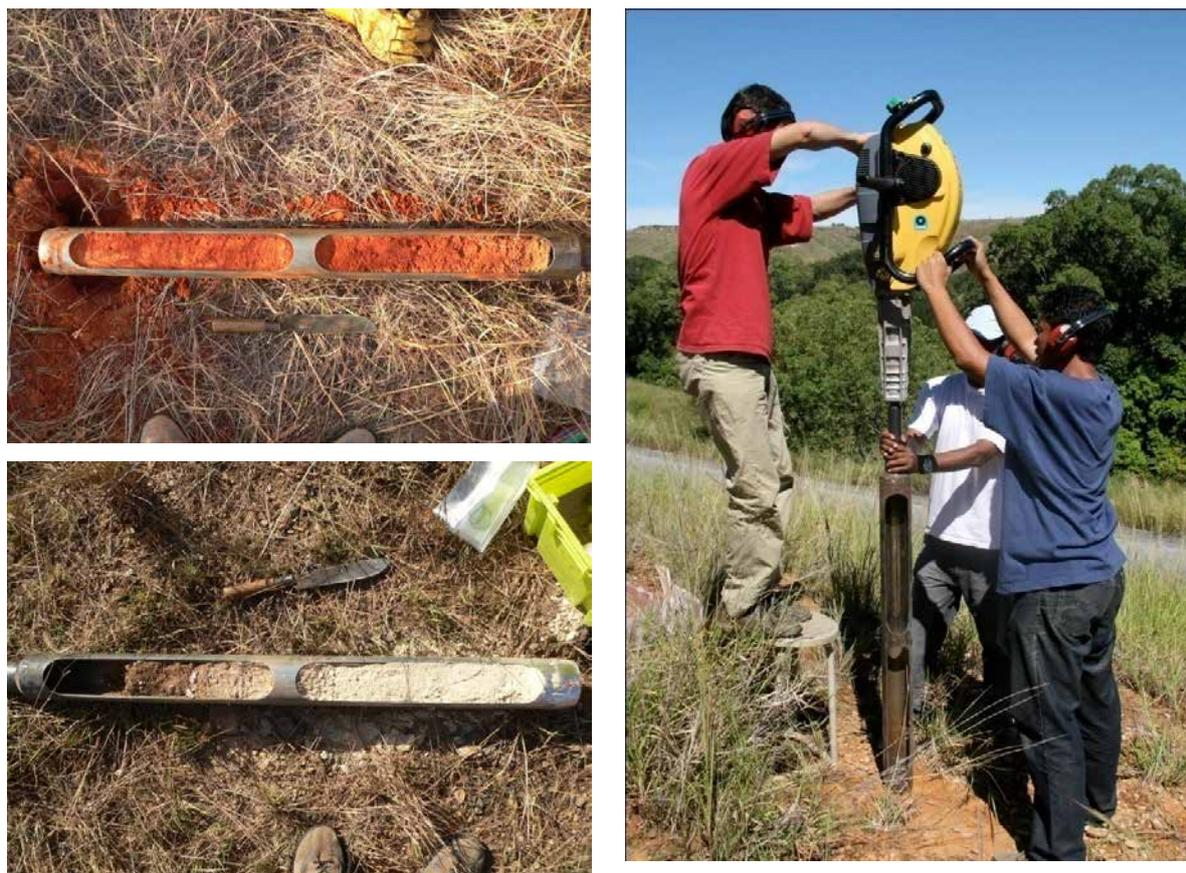
Photo 2-1: Prélèvement au carottier sur 1 m de profondeur
