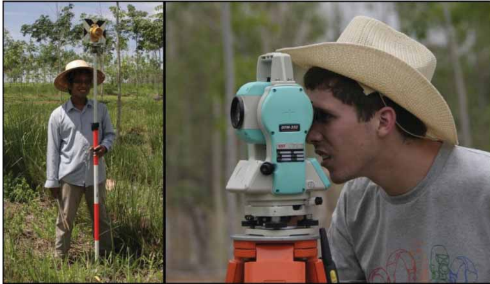
Figure 7 : Mesures topographiques avec le tachéomètre Nikon DTM-332.
