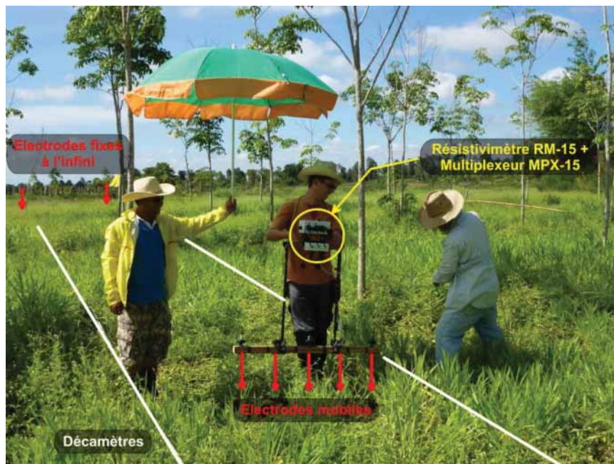
Figure 15 : Equipement utilisé pour la cartographie de résistivité électrique sur le site de Ban Non Tun.
