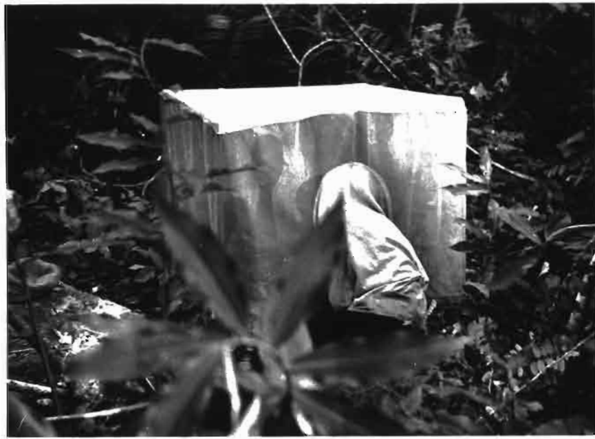
Fig. I3a - Une cage en forêt, noter le substrat rocheux affleurant, l'une des sources de difficultés rencontrées lors de l'implantation des cages en forêt.
