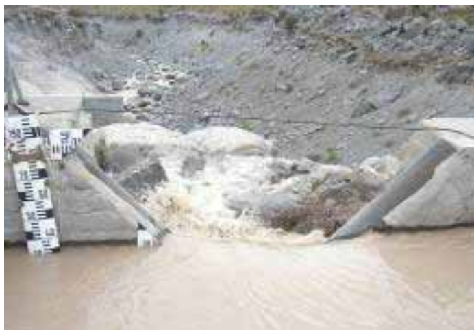
Foto 6.2. Vteredero trapezoidal y regleta. Estación “Los Crespos”
