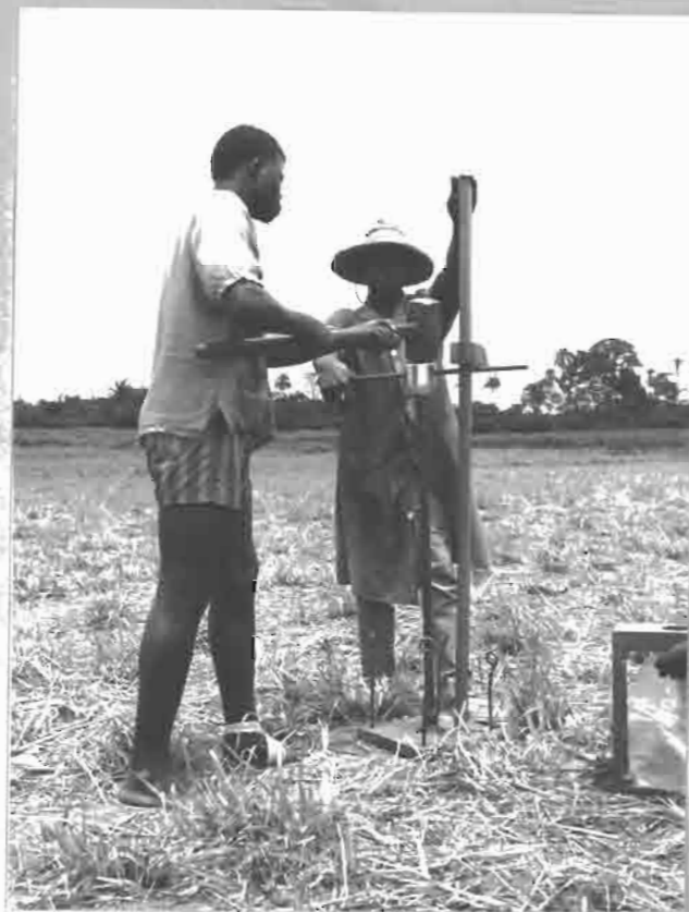
15 - Enfouissement de la sonde
