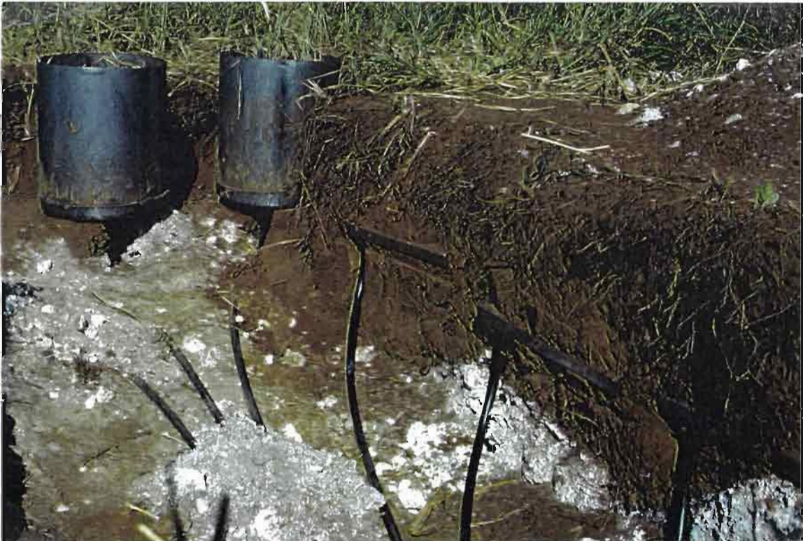
Figure 6 : Matériel de suivi hydrique et minéral : (a) T.D.R. , (b) tensiomètres à mercure et bougies poreuses, (c) tensiomètre à capteur de pression, (d) station météorologique, (e) tubes et plaques lysimétriques.
