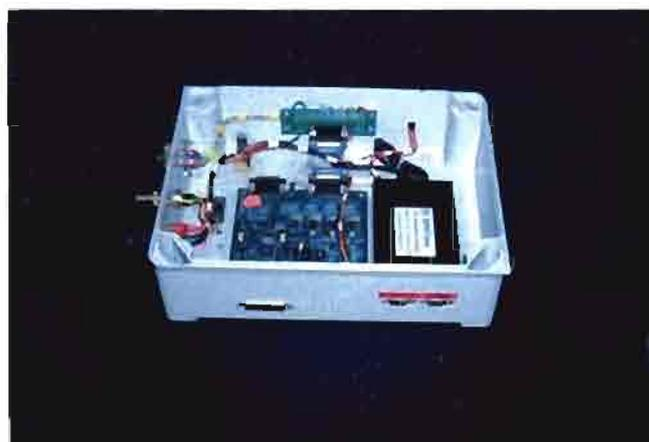
Fig . 1 : La carte d'acquisition et le GPS<sup>5</sup> intégrés dans le même boîtier
