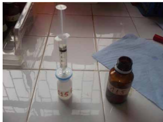
Photo 20 : Filtration du mélange sol-solution K_2SO_4
