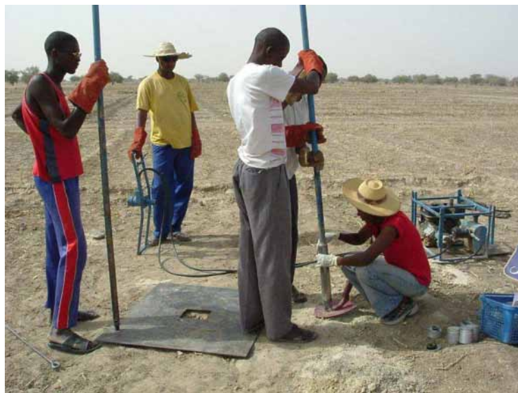
Figure 3.6. Forage à la tarière motorisée sur le site KJ en juin 2010.
