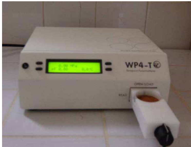
Figure 3.7. Potentiomètre WP4-T utilisé pour la mesure en laboratoire du potentiel matriciel.
