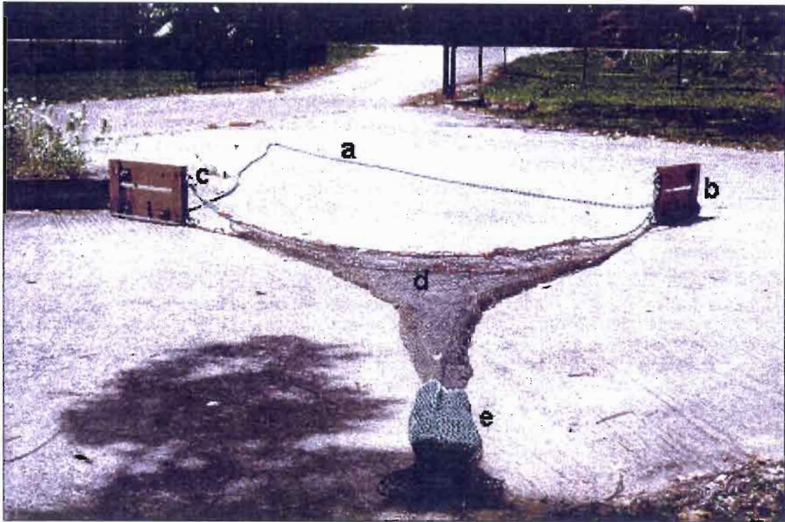
Photo 8.4.1 : Chalut d'essai professionnel ou "Try-net" utilisé lors de la campagne à bord de la "Polca". (a) chaîne gratteuse ; (b) et (c) panneaux divergents ; (d) corps du chalut ; (e) poche du chalut où on distingue en vert le doublage extérieur du fourreau protecteur (d'après Lhomme, 1989, cliché Lhomme).
