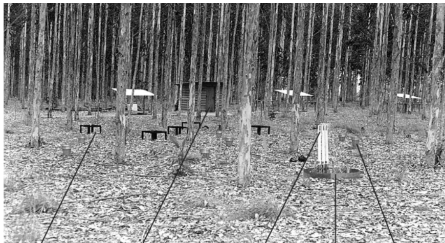
piège à feuilles (LAI) centrale d'acquisition des données tensiomètre ( \Psi_{sol} ) sonde à neutrons (R) pluviomètre ( P_s )
