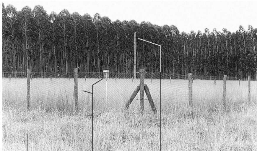
sonde thermique ( T_{sol} ) pluviomètres ( P_i, P_s ) anémomètre ( v ) bilanmètre ( R_n ) pyranomètre ( R_g ) sonde psychrométrique ( H\%, T_{air} )
